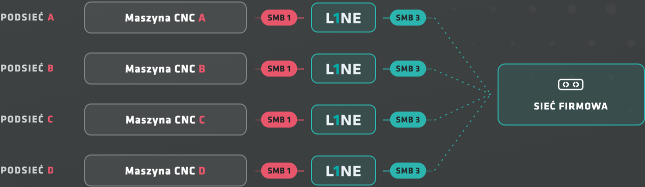
Rysunek: Integracja maszyn CNC z siecią firmową z LINE
