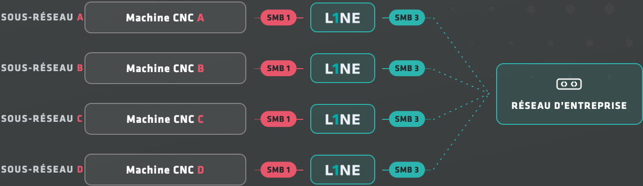
Illustration : intégration de machines CNC dans le réseau d'entreprise avec L1NE
