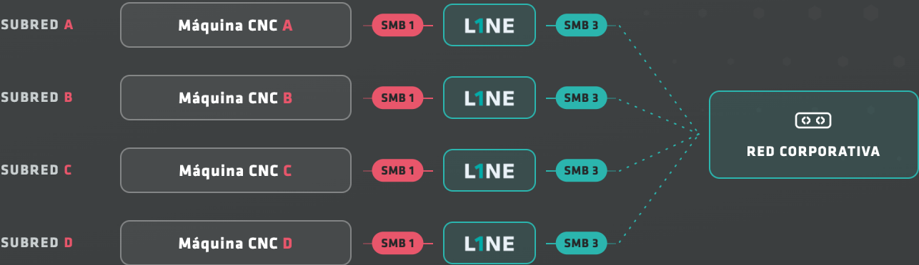
Figura: integración de máquinas CNC en la red corporativa con L1NE
