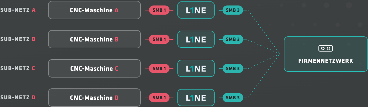
Abbildung: Integration von CNC-Maschinen ins Firmennetzwerk mit L1NE
